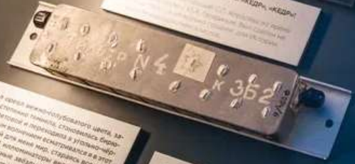
Фильтр радиопомех радиостанции космического корабля «Восток» Создан в ЦУП. Специально для 12 апреля 1961 года был установлен на орбиту, доставленный из Москвы космонавтом Ю.А. Гагариным в апреле 1961 г. Гос. архив космонавтики.
